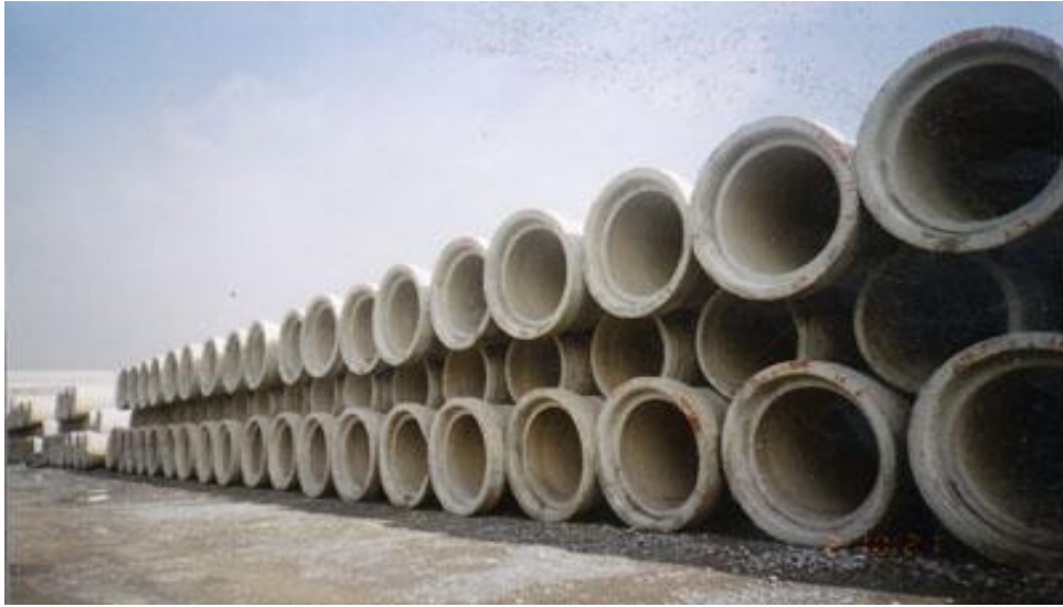
Cống ly tâm hiện đại, có thể sản xuất công bê tông có đường kính từ DN300 – DN2500, đáp ứng theo tiêu chuẩn BS 5911
